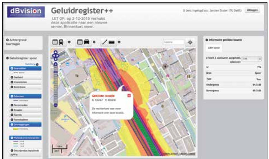
Figuur 5 - Geluidregister++ van dBvision: een webapplicatie waarbij de gebruiker het effect van een (hoger) geluidscherm eenvoudig kan laten berekenen in 3D.
