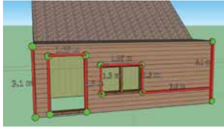
Figuur 7 - 3D-scanning van punten wolken via een tablet (Google Tango). Automatisch inpassen en meten van verschillende ontwerpen van carports biedt burgers de mogelijkheid om zelf onderzoek te doen bij een vergunningsaanvraag en om zelf 3D-data te produceren. Bron: Ordina.
